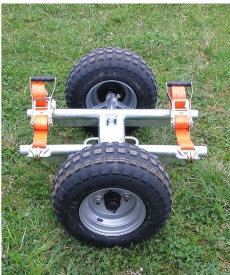
Dank den starken, verstellbaren Laufachsen und den optimalen Rädern kann der Rohrtransport-Wagen auch in unwegsamem Gelände eingesetzt werden.
